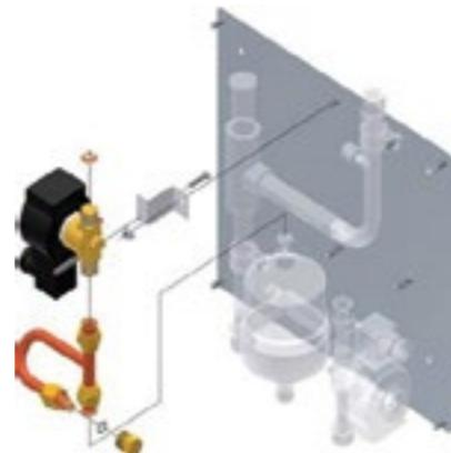
Questo accessorio permette di utilizzare l'impianto frigorifero per riscaldare il vano di carico e conservare la temperatura impostata anche in ambienti con temperatura inferiore a quella richiesta.
