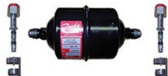
Il sistema è dotato di filtro deidratatore standard che garantisce l'eliminazione dell'umidità dal circuito durante il normale funzionamento dell'impianto. E' possibile aggiungere un secondo filtro che permette intervalli di manutenzione più lunghi.
